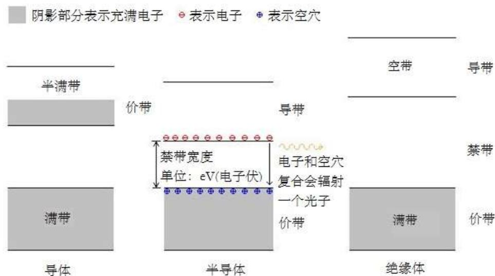
图 3 导体、半导体与绝缘体的能带示意图
